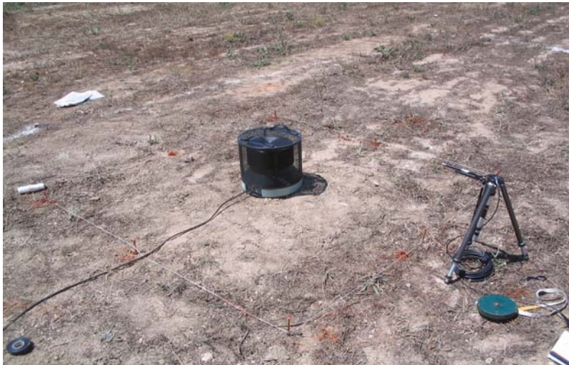
Fig. 9 Immagine raffigurante la sorgente oggetto di prova e il relativo microfono posizionato su apposita asta.
