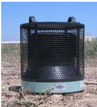
Fig. 3 . Sorgente puntiforme Bruel & Kjaer tipo "4204"
